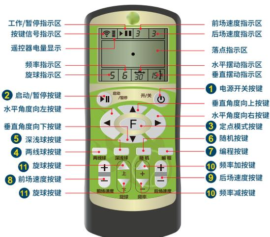
说明: 请在机器开机后30秒内长按电源开关键6秒配码, 没有经过配码的遥控器, 任何操作都无效, 最多可配16个遥控器。
